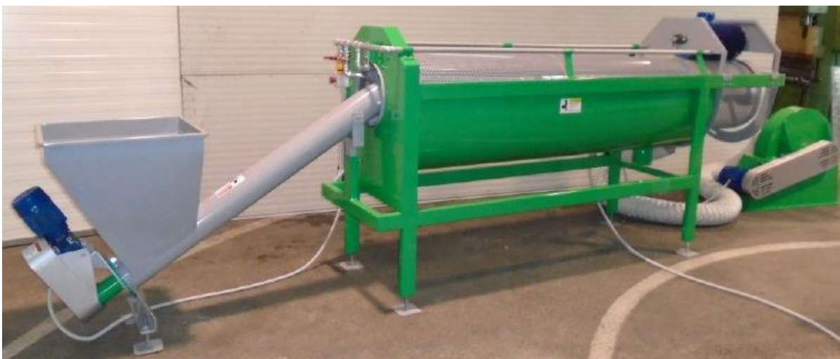
Slika 14. Uređaj za pranje bučinih sjemenki prije sušenja Sušara kontejnerska podna s pokretnim podom, s miješalicom i plinskim termogeneratorom
